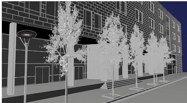
Doch damit nicht genug! PYTHA kombiniert die traditionelle OpenGL-Technik mit modernsten Möglichkeiten der 3D-Darstellung. Bei Bedarf können Sie direkt in der Konstruktionsoberfläche eine Schattenberechnung aktivieren. Diese erzeugt in Echtzeit einen pixelgenauen Schlagschatten. Das bedeutet – dass, sobald Sie Objekte konstruktiv verändern – sich sofort auch deren Schatten anpasst.
